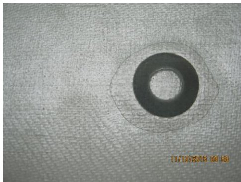
Obr. 13 Vzorek pro ultrazvukovou IR termografii
